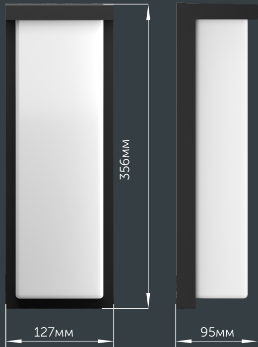
Габариты светильника Sova
